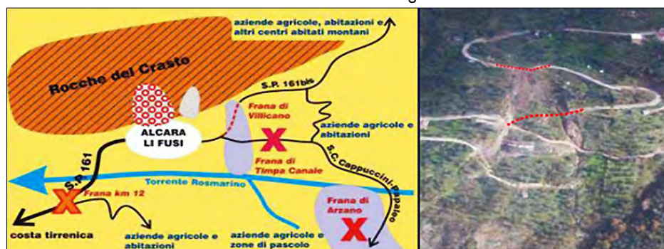
Alcara Li Fusi - Frana che coinvolgono la S.P 161
